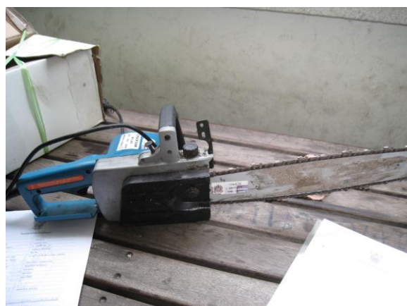
เลื่อยโซยนต์เครื่องจักรกลต้นกำลัง “มอเตอร์ไฟฟ้า”
