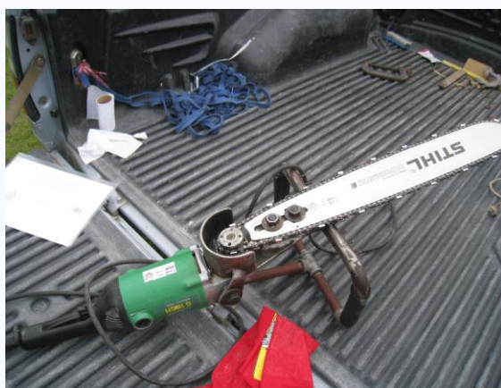
เลื่อยโซยนต์ดัดแปลงเครื่องจักรกลต้นกำลัง “ไฟฟ้า(มอเตอร์)”
