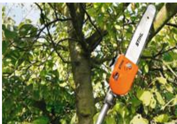
เลื่อยโซยนต์ประเภทแขนยาวสำหรับลิดตักแต่งกิ่ง(Pole pruner saw)
